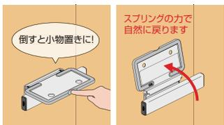
指でボード部を手前に倒すと、小物を置くことができます(重さ500gまで)。置いてある物を取るとスプリングの力により元に戻ります。
